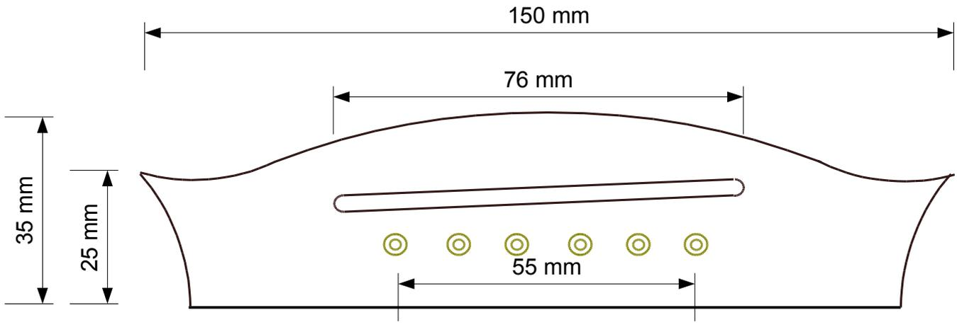
Äußerer Abstand der Bohrungen für die Pins entspricht der Griffbrettbreite am 12. Bund
